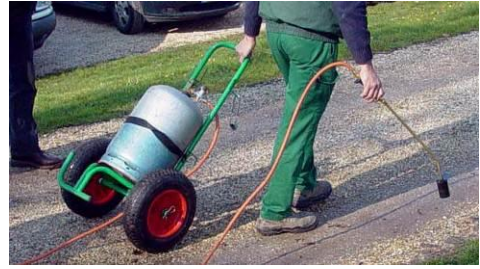
Désherbeur thermique à flamme directe par gaz. Source : FREDON Lorraine
